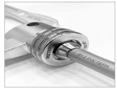
3. Проведите экспандирование трубы PE-X в три этапа (30%, 70%, 100%), между этапами проворачивая экспандируемую трубу на 30° вокруг своей оси
