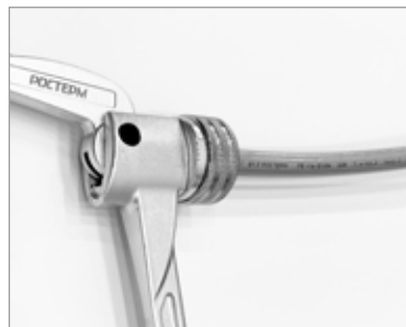
2. Вставьте наконечник насадки в трубу PE-X
